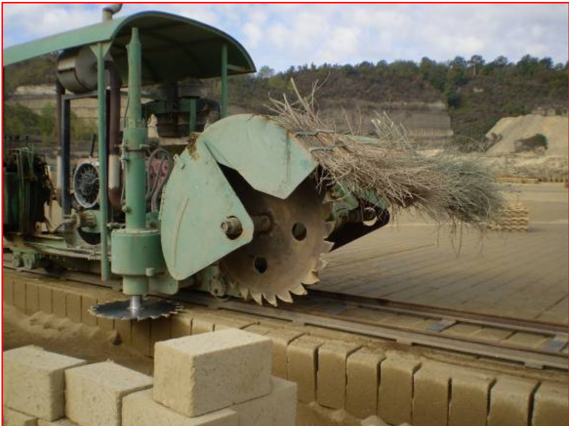
Operazione di taglio del banco di tufo per l'estrazione dei mattoni
